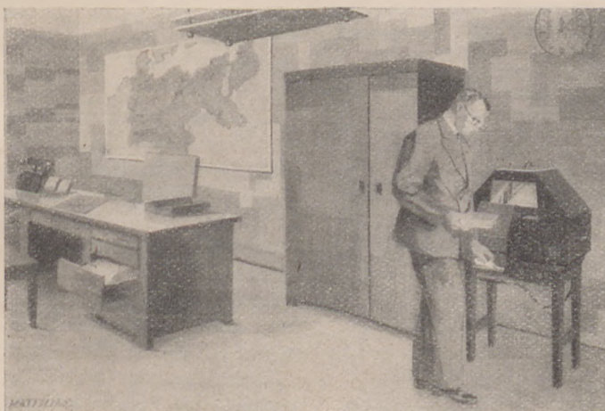
Abb. 2. Kleiner Apparat, kostet nicht viel mehr als eine Schreibmaschine und liefert Kopien bis DIN A 5
