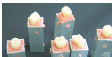
Zdj. 2. Zęby umieszczone w aluminiowych bloczkach
