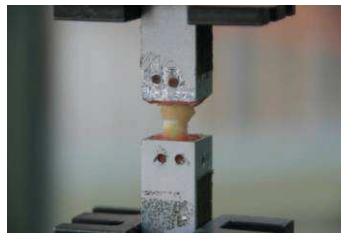
Zdj. 9. Próbka w maszynie rozciągającej przed zerwaniem
