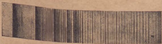
1. Widmo łuku węglowego, otrzymane za pomocą siatki dyfrakcyjnej.
