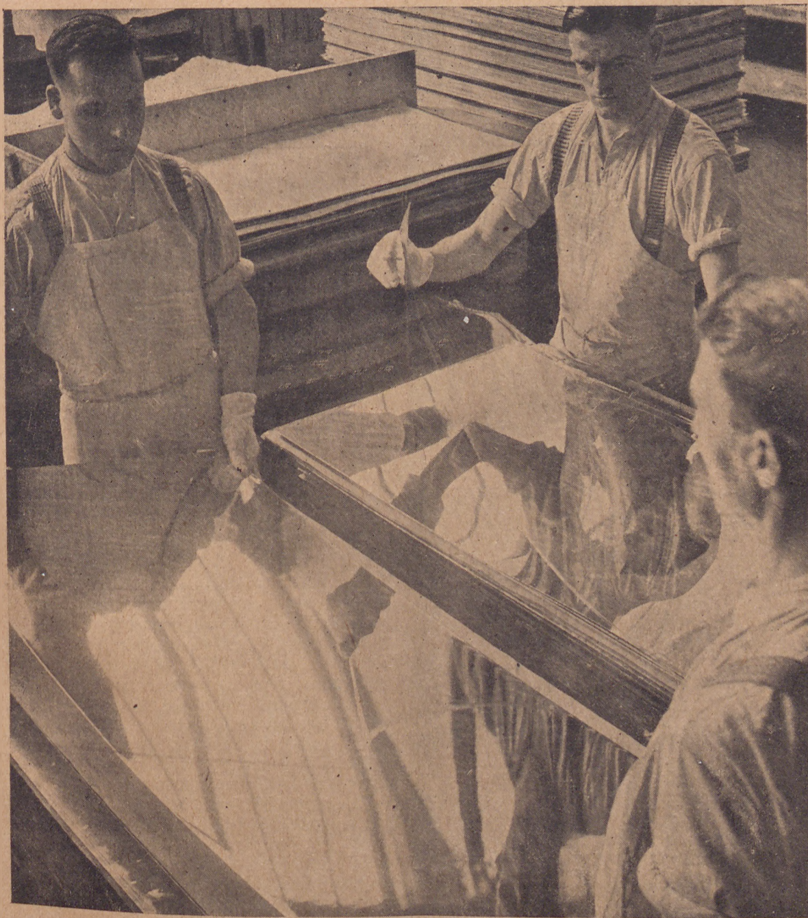
Produkcja ksylonitu, jednego z najbardziej znanych „plastyków”. Ostatnia faza przeróbki: nadawanie połysku przez ogrzewanie i ochładzanie pod wysokim ciśnieniem na lustrzanej tafli metalowej.
