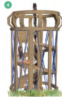
4 Moduł zjeżdżalnia konstrukcja, oraz ślizgawka, została wykonana z drewna, jako zabezpieczenie wykorzystano linę.
