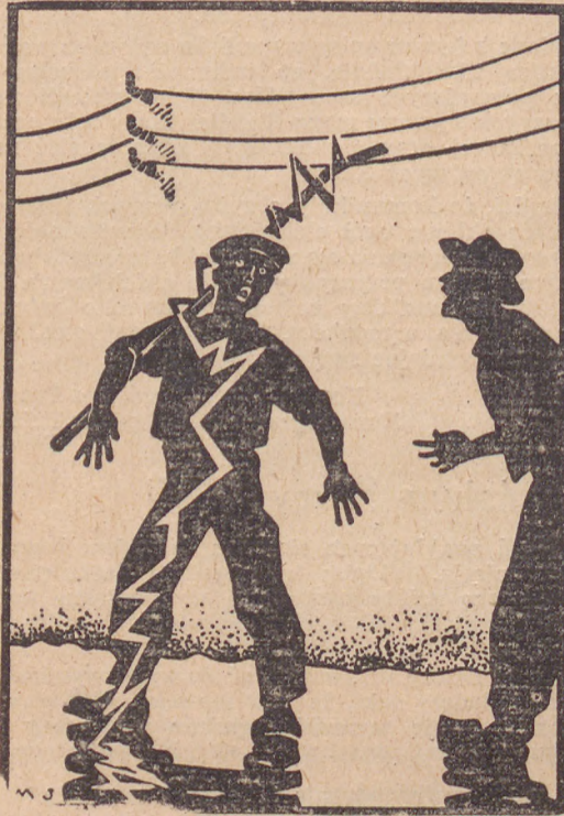
Rys. 1. Niebezpieczeństwo przy zawadzeniu prętem metalowym o gołe przewody
