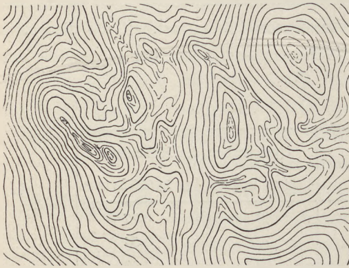
Abb. 3. Gelände von Abb. 1 mit Hilfhöhenlinien wie im Musterblatt für die topographische Karte 1 : 25 000 vorgesehen. 20-m-Linien bei Neigungen von über 20°, 10-m-Linien zwischen 15° und 20°, 5-m-Linien zwischen 5° und 15°, 2 \frac{1}{2} -m-Linien zwischen 4° und 5° und 1 \frac{1}{4} -m-Linien unter 4°. Die 100-m-Linien sind stärker gezogen. Gute geometrische Erfassung der Geländeformen an den Verebnungsflächen, jedoch empfindlich gestörter plastischer Effekt.
