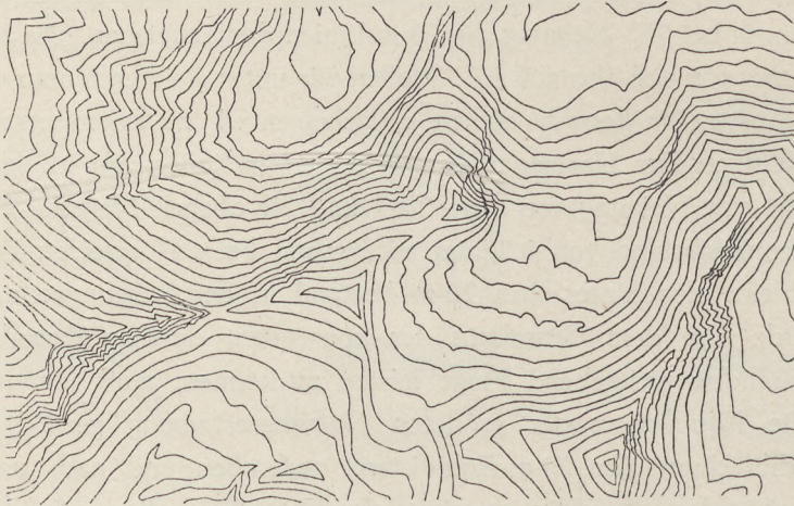
Abb. 8. Höhenlinienplan eines kantigen Geländes
