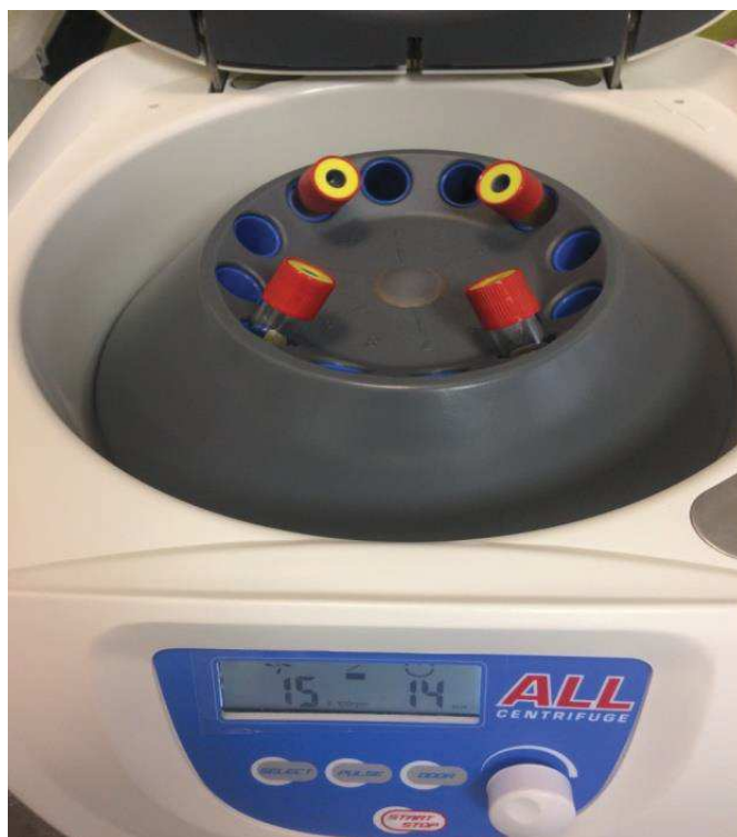
Rycina 5. Sposób umieszczenia probówek w wirówce
