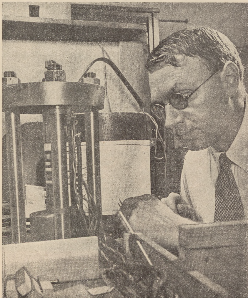
W jaki sposób ciepło Ziemi dobiega do powierzchni? Dr F. Birch biedzi się nad rozwikłaniem szczegółów tego zagadnienia przy pomocy specjalnego przyrządu określającego przewodnictwo różnych skał.
