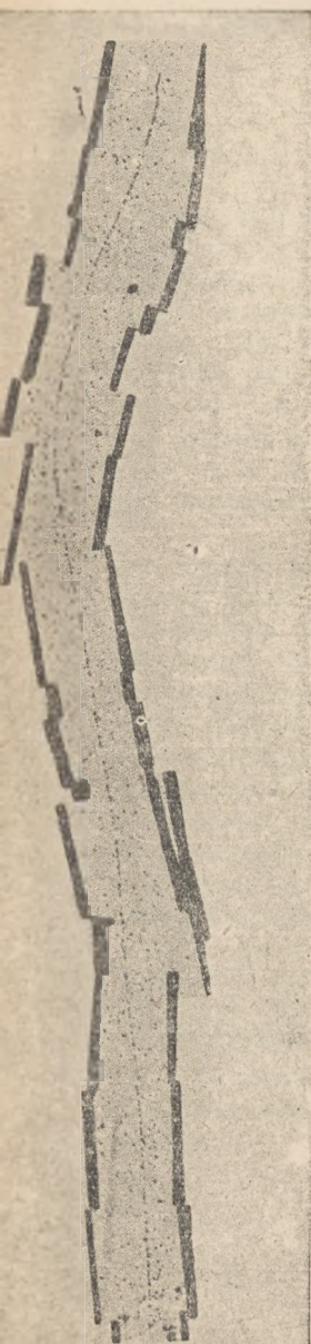
Ryc. 6 Mikrofotografia śladu mezonu w powiększeniu 430-krotnym. Tor mezonu jest zbyt długi, by mógł wyjść na zdjęciu. Dlatego zdjęcie powyższe stanowi mozaikę z kilkunastu fotografii, odpowiednio ze sobą sklejonych. Poza tym tor mezonu nie wyszedłby ostro w całej swej długości na jednym zdjęciu, gdyż nie przebiega równoległe do powierzchni emulsji
