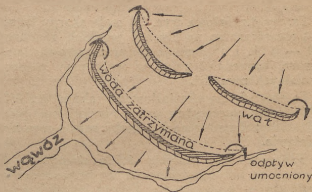
Rys. 13. Ochrona stoku przez obwałowanie (wg. Kozmenko).
