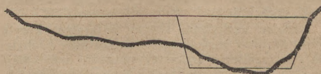
Rys. 2. Schemat zamiany koryta naturalnego na równoważny przekrój normalny.
