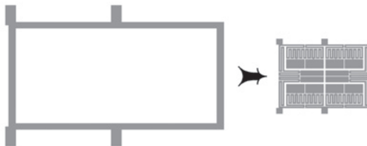
Rys. 4. Miniaturyzacja sprzęgacza pierścieniowego. Od lewej: układ konwencjonalny, układ zminiaturyzowany przy użyciu komórek rezonansowych
