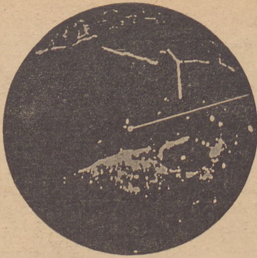
Ryc.3. Obraz (plan) terenu na ekranie oscyloskopu w odbiorniku radarowym: jasny punkt po środku — położenie własne; linia prosta — kierunek kursu statku.
