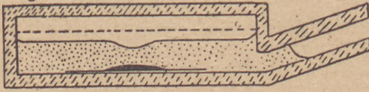
Naczyńka używane do hodowli tkanek, przedstawiona w przekroju. Tkanika zaznaczona czarno, pożywka kropkowana. U góry „kropla wisząca” na szkiełku, u dołu flaszka Carrela. (wg Fischer'a).
