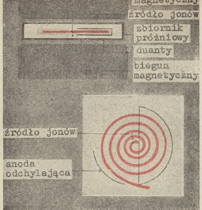
Synchro-cyklotron. Tor cząstki podobny do poprzedniego, ale brak jednego duantu. Masa cząstki ulega tu zwiększeniu
