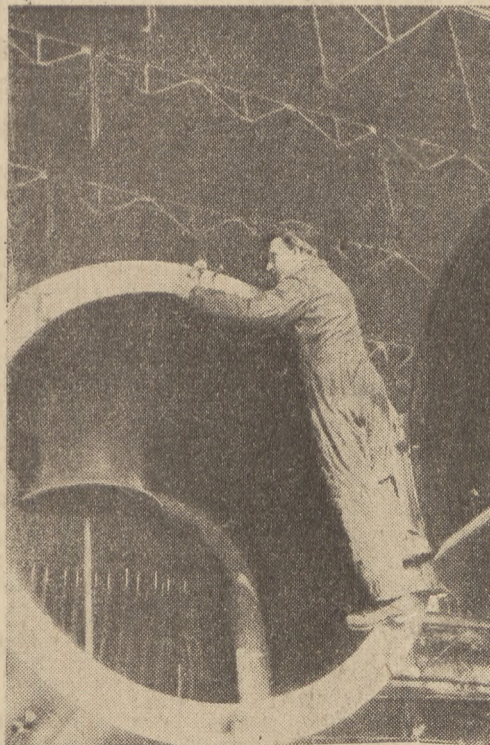
Montowanie rur wlotowych w parowozach Fot. W. Kondracki Film Polski
