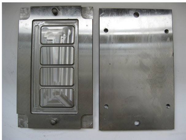
Rys. 157 Zdjęcie formy wykorzystywanej do wytwarzania przeciwbłotnej osłony poliuretanowo-gumowej.
