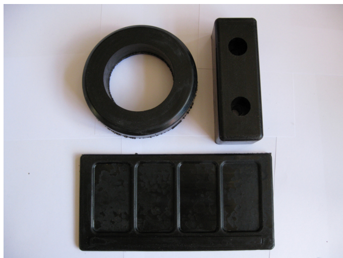
Rys. 158 Zdjęcia wyrobów, uzyskanych z kompozytów poliuretanowo-gumowych serii KPG-C
