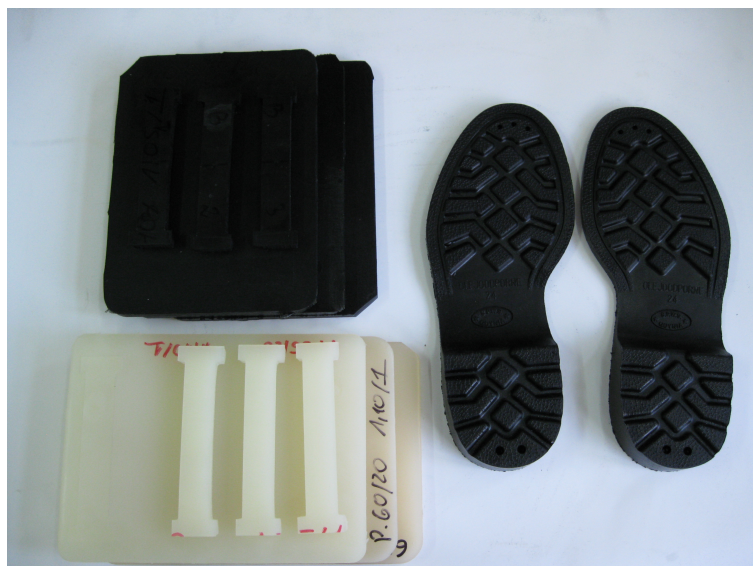
Rys. 159 Zdjęcia próbek kompozytów poliuretanowo-gumowych przeznaczonych do badań wielokrotnego zginania oraz przykładowe podeszwy wykonane z KPG-1.
