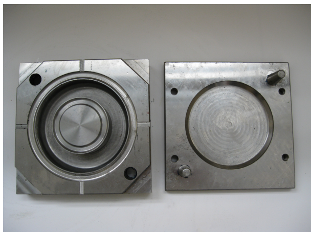
Rys. 155 Zdjęcie formy wykorzystywanej do wytwarzania opon poliuretanowo-gumowych.
