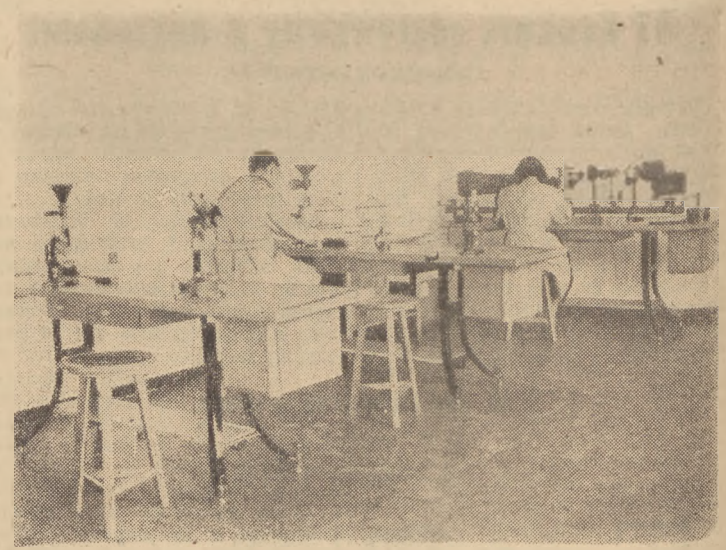
Fragment sali mikroskopów metalograficznych, w której przeprowadzane są wstępne badania nad gatunkami stopów. Opinia eksperta decyduje o produkcji.
