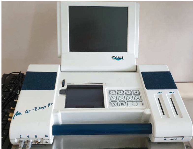
Rycina nr 20. Przepływomierz dopplerowski Multi Dop P firmy DWL do badania tętnic mózgowych w Pracowni Ultrasonografii Dopplerowskiej Oddziału Neurologii i leczenia Udarów Mózgu w Wojewódzkim Szpitalu Wielospecjalistycznym w Słupsku.
