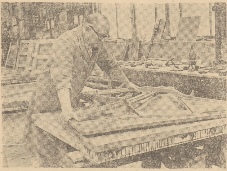
Na całość konstrukcji pianina składa się, jak widać, praca stolarza — płyta rezonansowa, zewnętrzne pudło, klawiatura, następnie metalowa — odlewanka, którego dziełem jest rama z lanego żelaza, gwarantująca trwałość stroju. Mechanizm młoteczkowy, wykonany znowu gdzieś indziej, założy się już do stojącego, gotowego pianina. Na zdjęciu moment zakładania ramy żelaznej.
