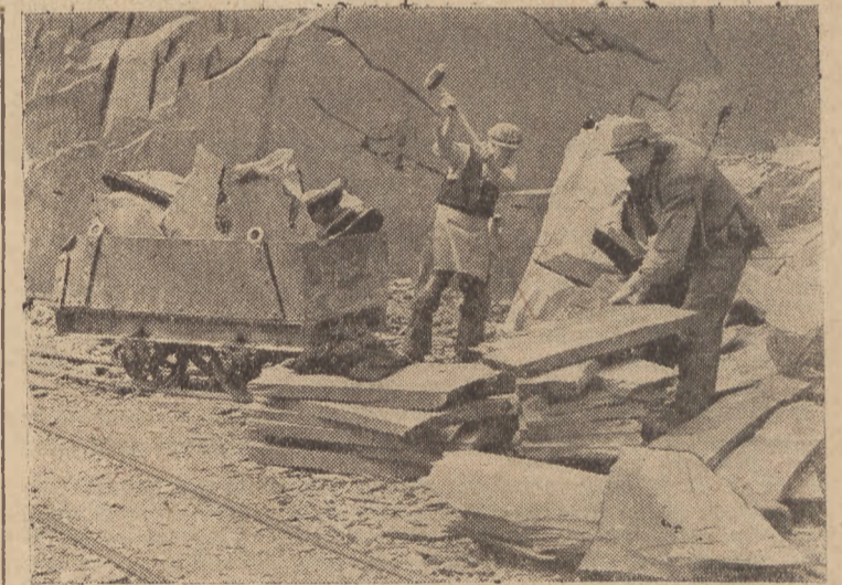
Pracownicy kamieniołomów rozbijają wielkie płyty łupku na czworokątne płyty, ładując je następnie na wagoniki kolejki wąskotorowej Foto SAP dla „Dziennika Zachodniego“
