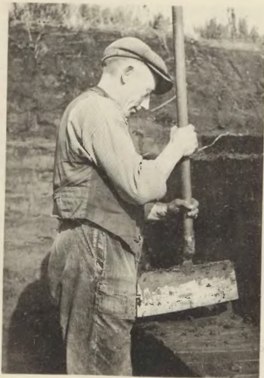
Vapenburger Torfstecher. Mit dem „Stecher“ werden die Soden vorgestoehen. Rechts eine Torfbank, dahinter die Torfwand des Stiches. Foto: Schulz.
