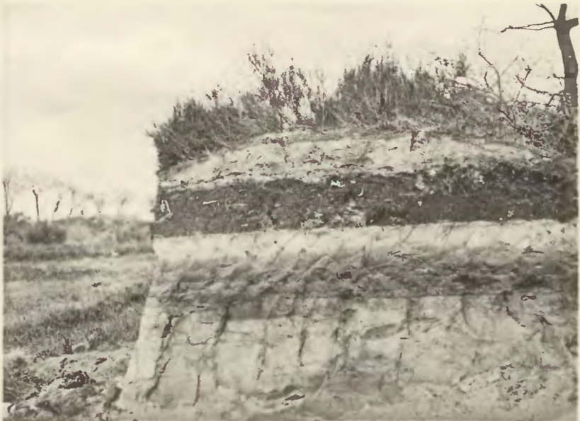
Aufschluß an der Straße Moorburg — Groß - Sander, Ostfriesl. Verheidede Flugsanddecke, Moor bzw. Torfschicht, Bleichsand, dunkel gefärbter Humus-ortsand, geschichtete, helle Schmelzwassersande. Aufnahme: Langerfeldt.
