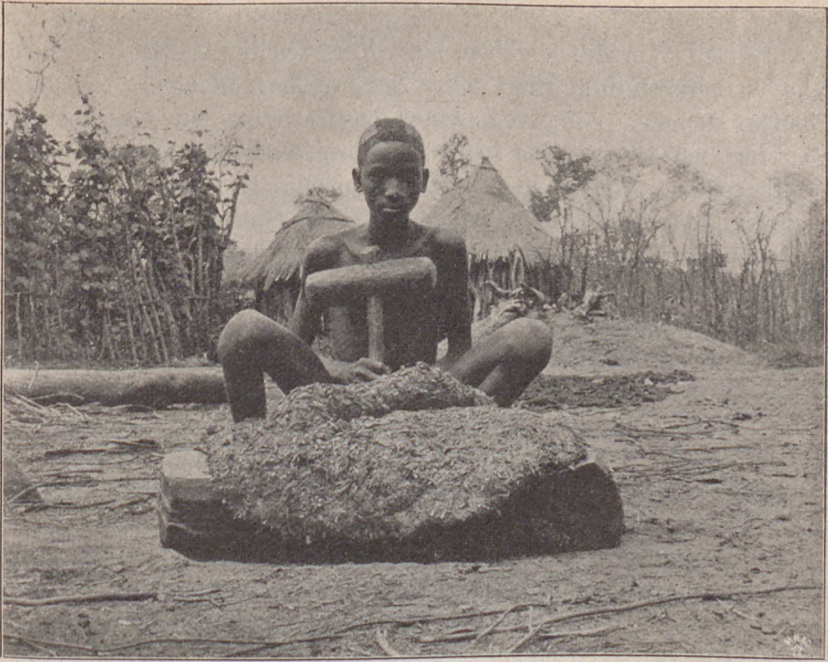
Fig. 4. Bereitung eines Kautschukkeuchens durch Hämmern.
