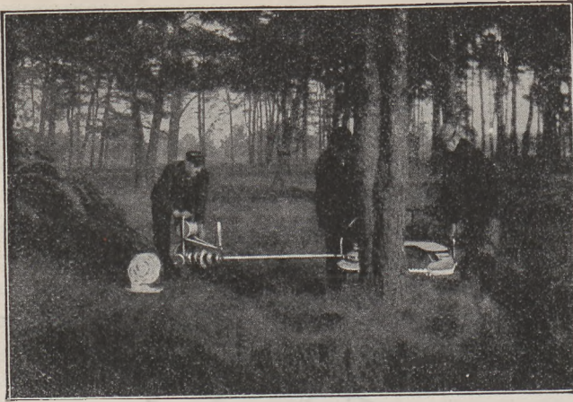
Abb. 3. „Sektor“ bei Ausführung eines wagerechten Schnittes.
