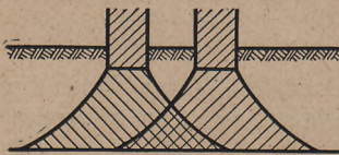
Bild 4. Überlagerung der Bodenbeanspruchung durch benachbarte Baukörper
