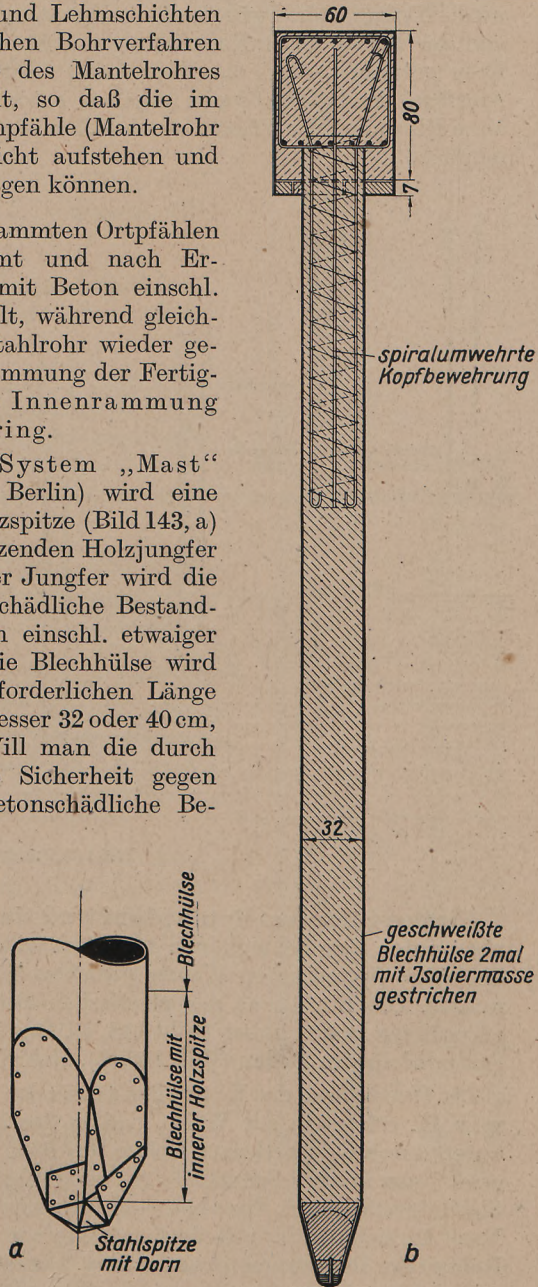
Bild 143. Bohrrammpfahl System „Mast“ a) Spitze der Blechhülse b) fertiger Pfahl
