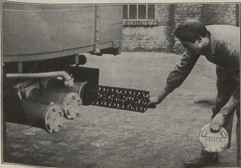
Abb. 6. Prallblechreiniger einer Holzgasanlage für Fahrzeuge.
