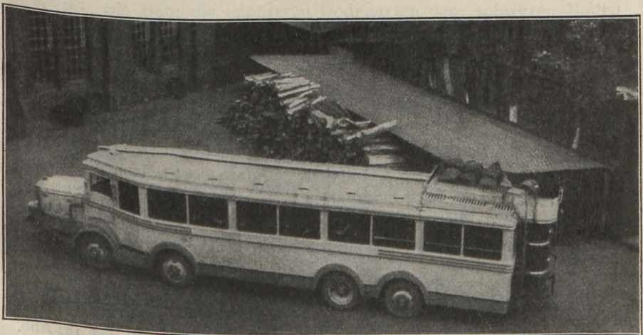
Abb. 13. 4-Achser-Autobus, Bauart Dr. Deiters, ausgerüstet mit Holzgenerator Imbert (Münster).
