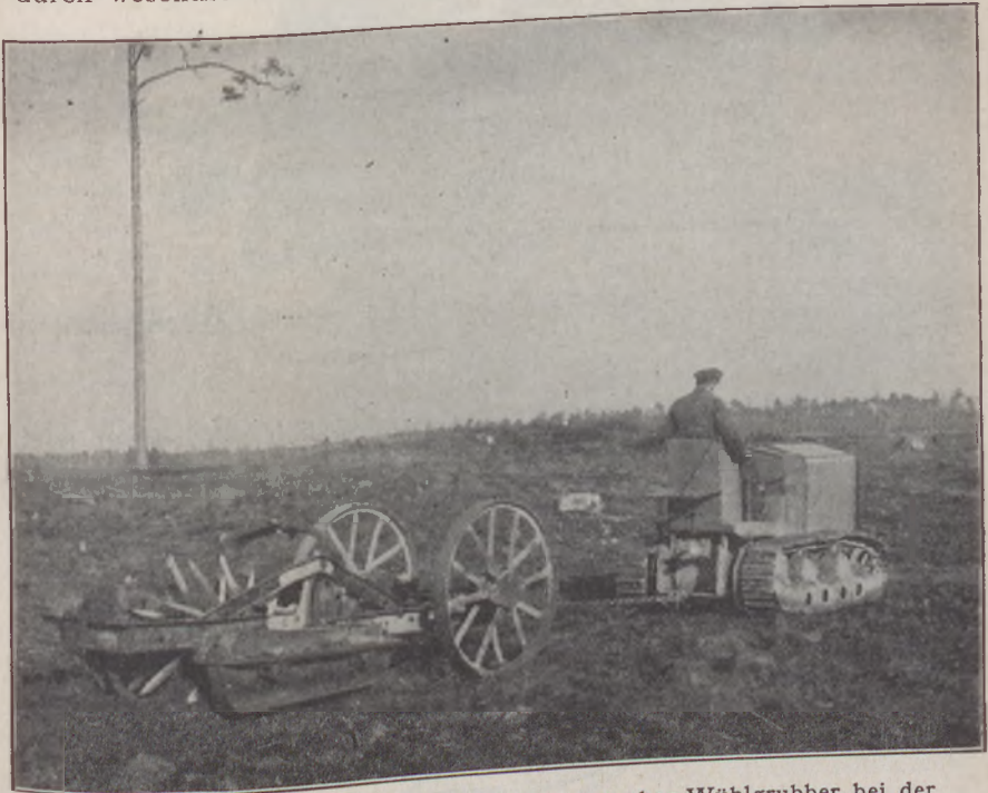
Abb. 1. Linke-Hofmann-Schlepper mit Geistschen Wühlgrubber bei der Urbarmachung von Waldboden.
