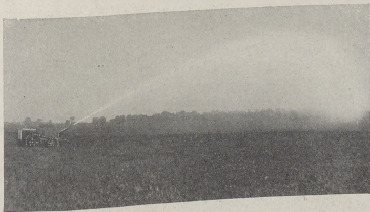
Abb. 8. Verwendung des Schleppers für Beregnungszwecke. (Zapfwellenantrieb.)
