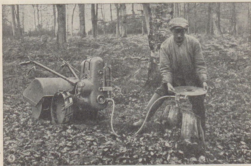
Abb. 9. Schleifen von Kolterscheiben mit Hilfe der biegsamen Welle. (Antrieb durch Kleinfräse.)
