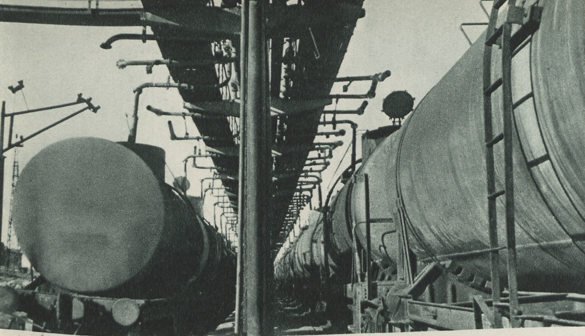
Разлив в цистерны готовой продукции нефтеперерабатывающего завода.
