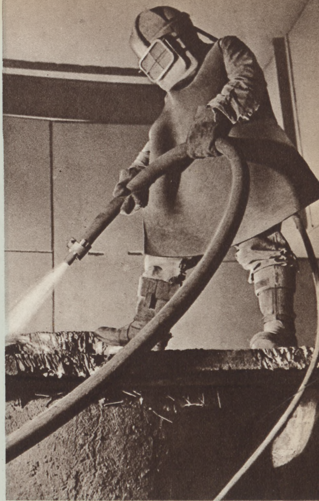
При очистке крупных отливок на Уралмаше применяется также особая защитная одежда для рабочих.
