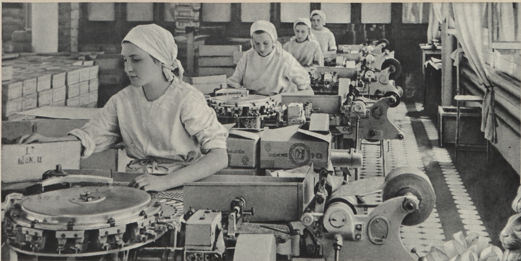
Цех заверточных машин на московской фабрике „Красный Октябрь”. Работают машинистки-завертчицы В. Карсавина, С. Шелкова, Л. Сильницкая и А. Черняева. Завертывание конфет вручную требует большого количества рабочих рук и обширных помещений. На советских кондитерских фабриках работают усовершенствованные заверточные автоматы. Они имеют высокую производительность, занимают небольшую площадь и резко повышают культуру производства.
