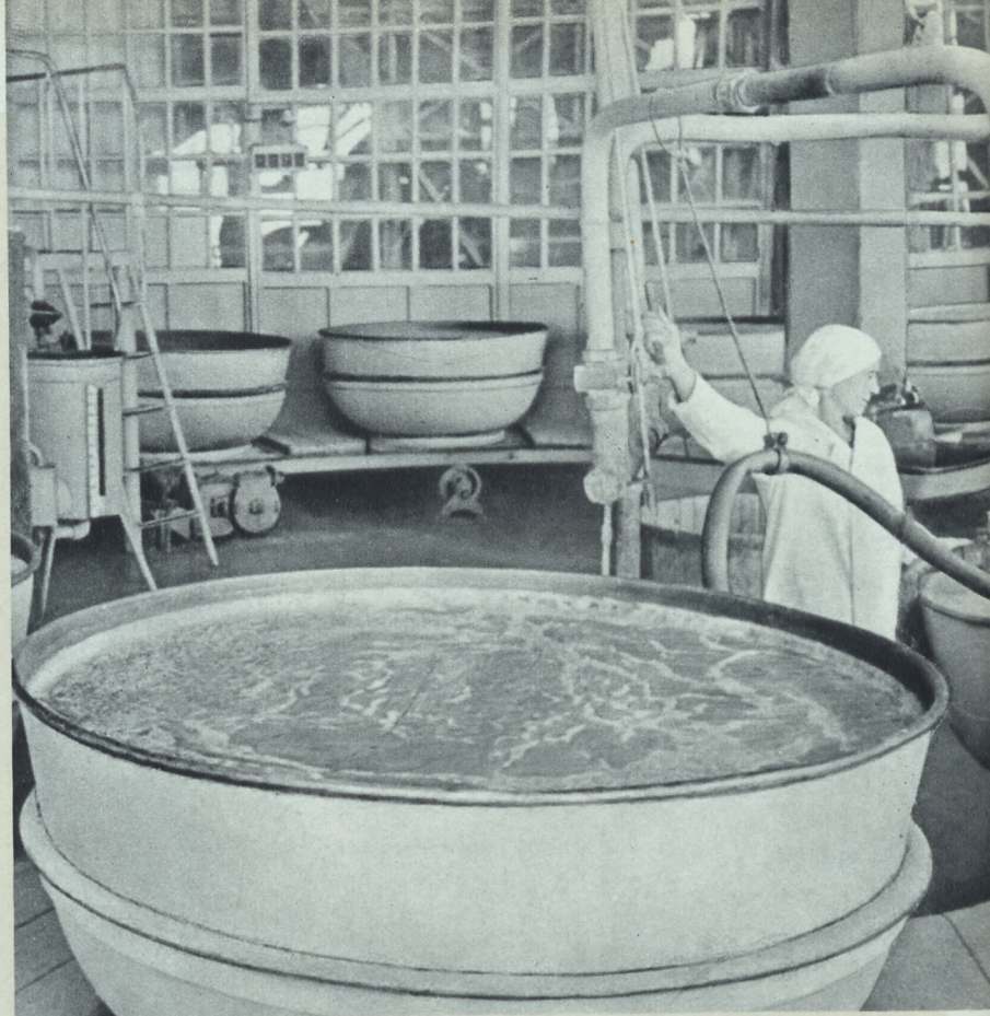
Дрожжевой цех хлебозавода. На кольцевом конвейере движутся чаны с жидкими дрожжами, приготовленными на этом же заводе. По мере готовности дрожжей они перекачиваются насосом в мерные баки дозировочного.
