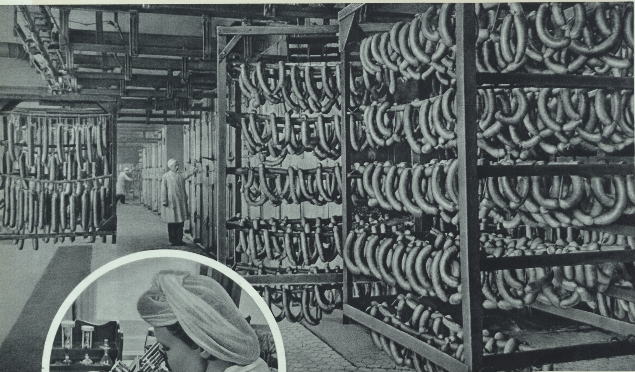
В термическом цехе колбасного завода московского мясокомбината. На втором плане видны копильные камеры, в которых обрабатываются горячим дымом излюбленные потребителями колбасы — московская, полтавская, краковская и другие.
