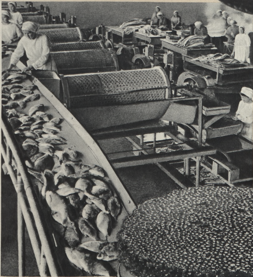
В цехе астраханского рыбозавода; транспортер подает рыбу к чешуеёмочным барабанам. На снимке справа — упаковка готовых балыков на московском рыбозаводе.
