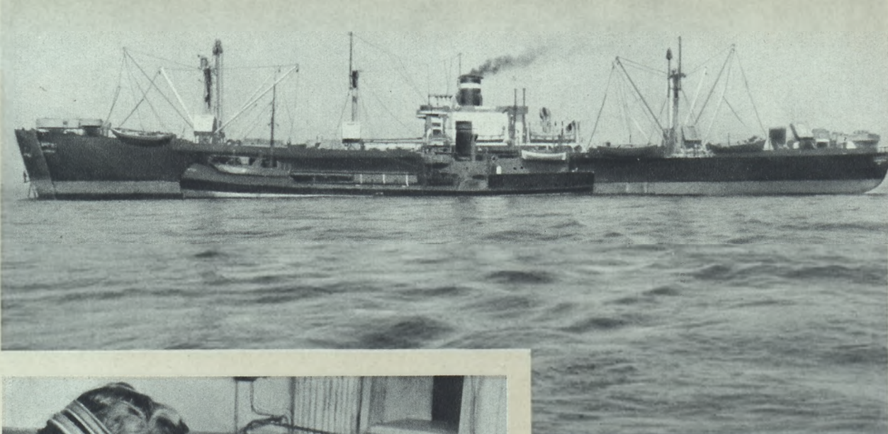
„Тунгус” — одна из пловучих баз экспедиционного лова рыбы. Во время промысла вдали от берегов „Тунгус” служит не только базой для многочисленных мелких рыболовных судов, но и перерабатывающим улов предприятием.
