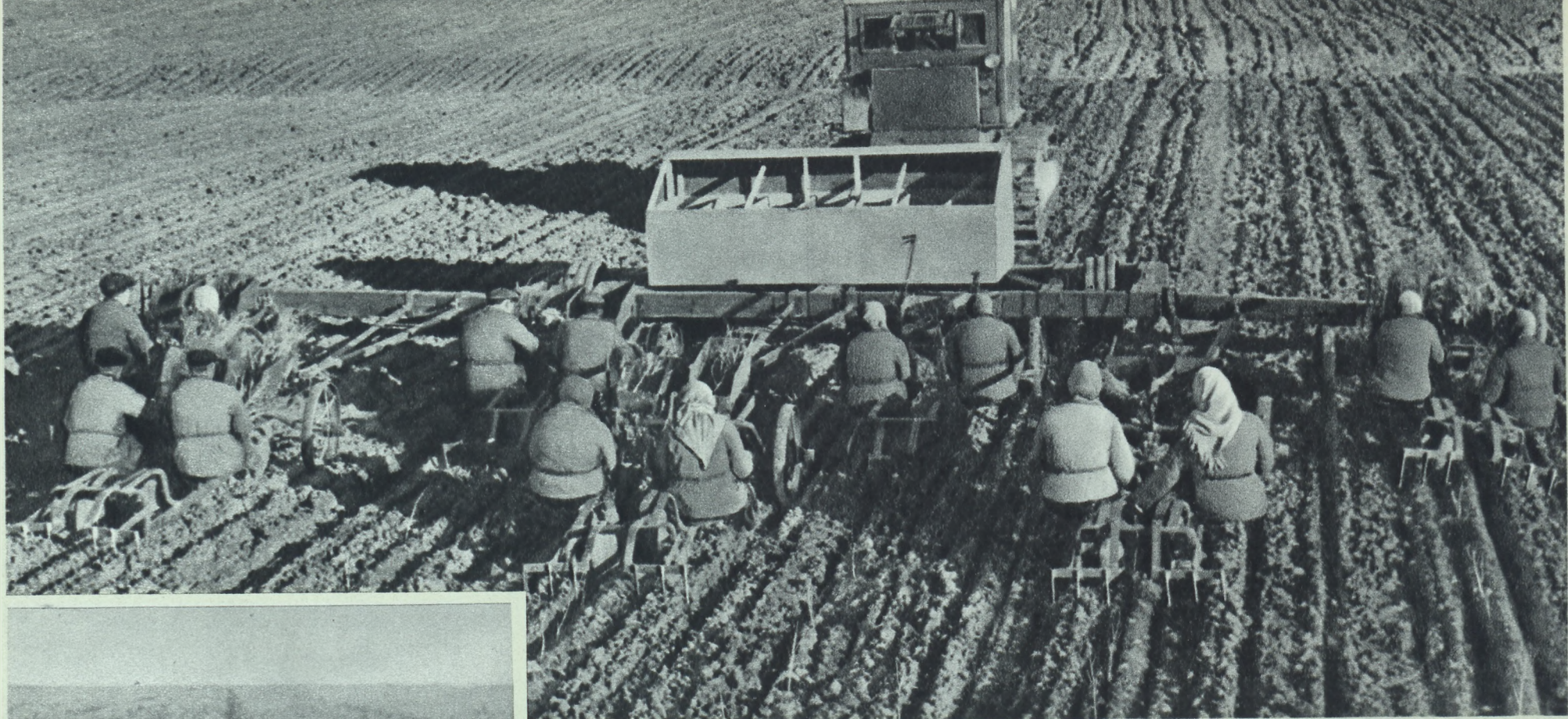
Советские конструкторы создали специальные машины для посадки леса. За день лесопосадочная машина может посадить лес на площади до 3 гектаров. На снимке: механизированная посадка леса в Сталинградской области.
