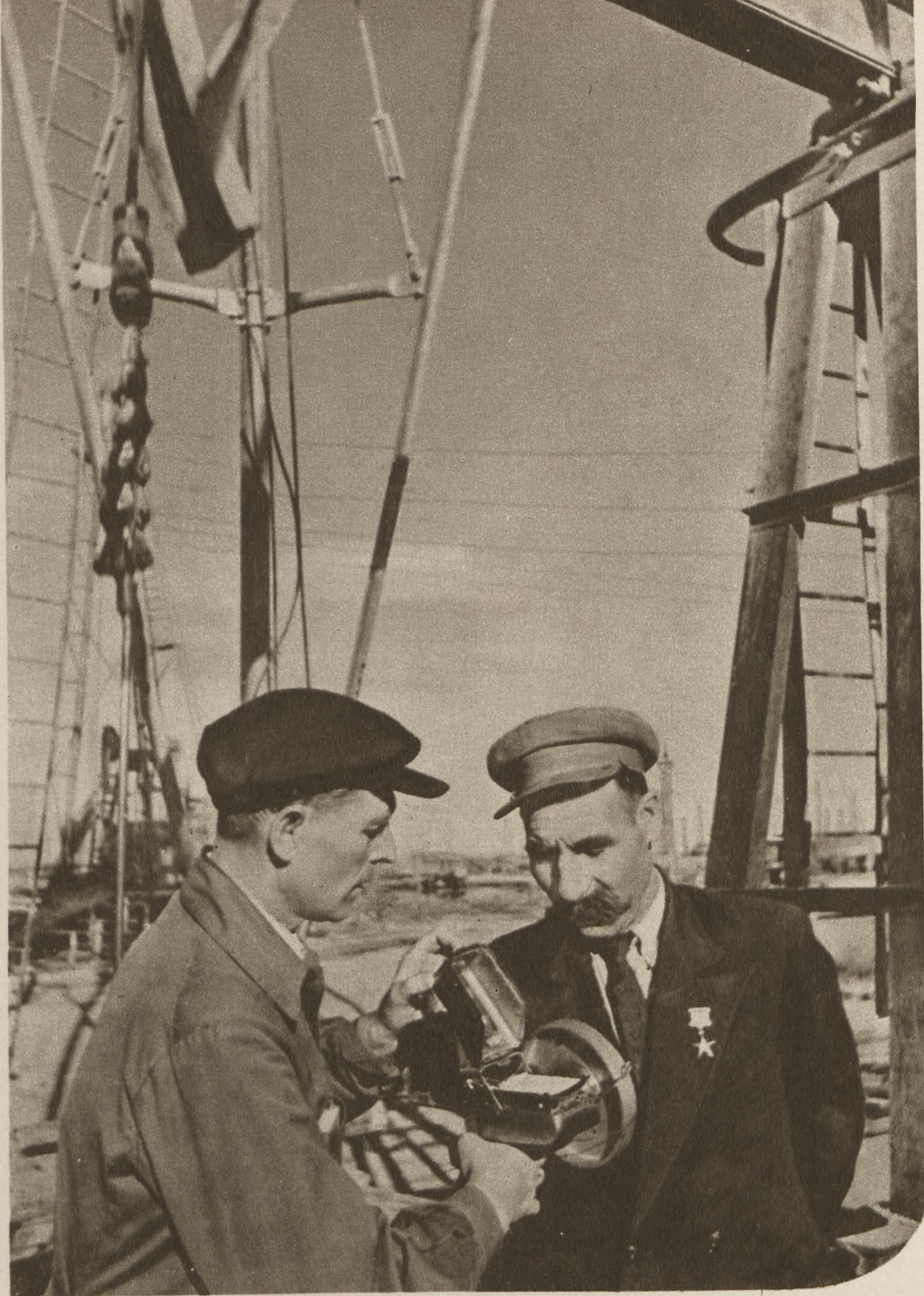
Мастер по добыче нефти П. Скворцов (слева) показывает Г. Алиеву записанную при помощи динамографа кривую, характеризующую работу глубинного насоса.
