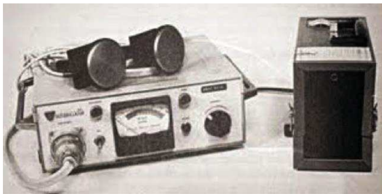
Rycina 2. Przenośny defibrylator skonstruowany przez prof. Frank Pantridge w latach 50 XX wieku [25].
