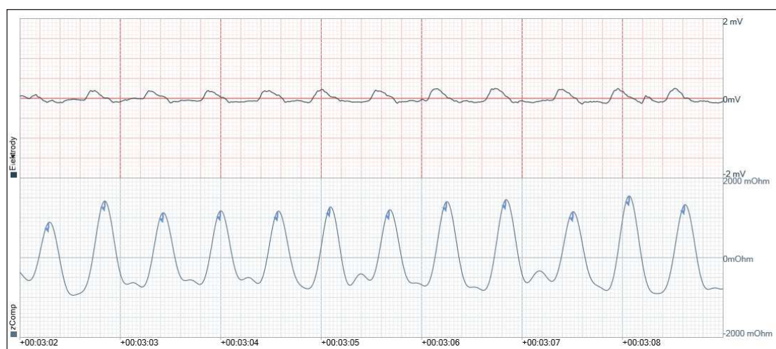
Rycina 16. Zapis z pamięci wewnętrznej AED. Pierwsza część przedstawia rytm serca, druga część prowadzoną kompresję klatki piersiowej [zbiór własny].
