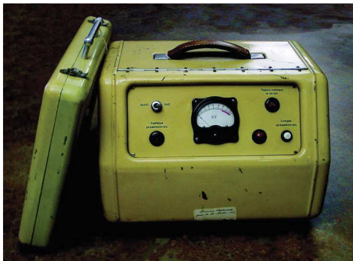
Rycina 3. Defibrylator ID-1-VEI skonstruowany w ZSRR w 1952 r. [13].
