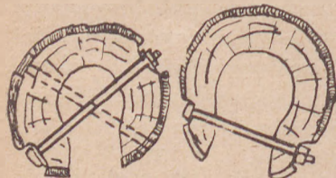
Ryc. 23. Sposób wzmacniania śrubami wypróchniałych pni.
