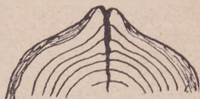
Ryc. 15. Przekrój pnia posiadającego szczelinę mrozową.
