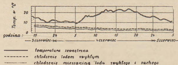
Rys. 1. Przebieg temperatur w czasie przewozu ryb wagonem lodownią.
