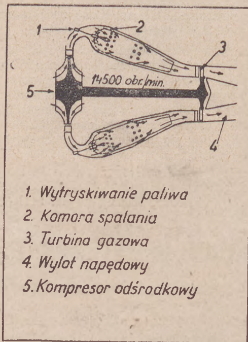
Ryc. 2. Schemat działania turbo-reakcyjnego silnika „Derwent“
