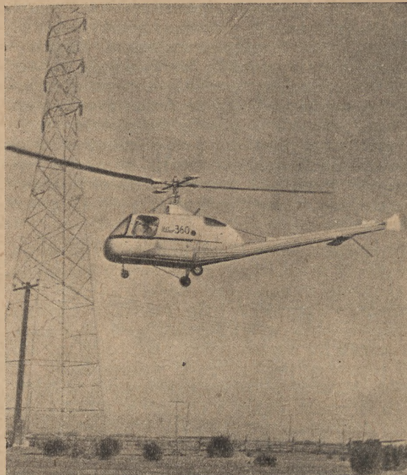
Odmiana handlowa helikoptera „Hiller 360“ w akcji kontroli nad przewodami napowietrznymi
