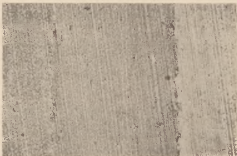
Abb. 3. Lampenruß (45 Teile), Acetylenruß (30 Teile) Gasruß (40 Teile) (in 100 Teilen Kautschuk, 35fache Vergrößerung)
