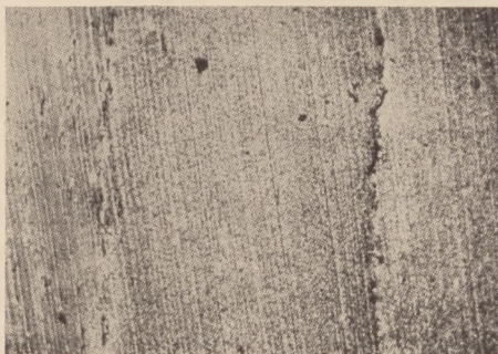
Abb. 4. Gasruß (40 Teile), Lampen+Gasruß (28+12 Teile), Lampenruß (40 Teile) (in 100 Teilen Kautschuk, 35fache Vergrößerung)
