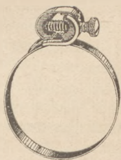
Abb. 8. Durch Befestigung des Bandes an der Mutterseite und Ueberleiten über das Widerlager wird große Spannwirkung bei kleiner Schraubenlänge erzielt
