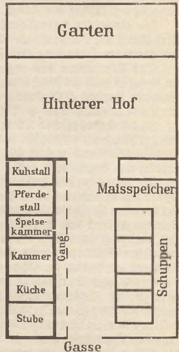
Abb. 1. Grundriß eines schwäbischen Bauernhauses im Banat
