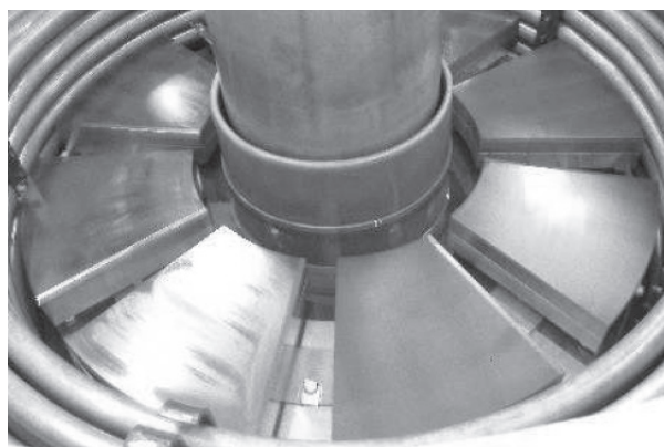
Rys. 1.47. Łożysko EW Mühleberg z pokryciem Polypad™ (napęczniony włóknem węglowym PEEK) po roku eksploatacji [132]
