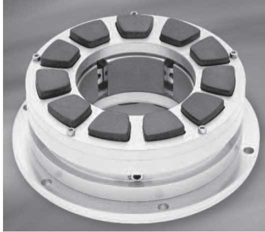
Rys. 1.48. Łożysko HYPERAX z segmentami w całości wykonanymi z kompozytu PEEK do zastosowań w ekstremalnie ciężkich warunkach działania (wysokich prędkości i smarowania cieczami zanieczyszczonymi o małej lepkości) [212]
