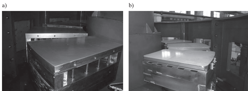
Rys. 1.31. Łożyska badane w największym na świecie stanowisku badawczym łożysk wzdłużnych w Harbin (Chiny); maksymalna siła osiowa 30 000 kN: a) łożysko o konstrukcji double-layer ; b) łożysko z pokryciem PTFE ([268])
