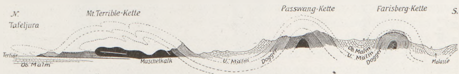
Fig. 179 Profil durch das Überschiebungsgebiet des nordschweizerischen Kettenjura (nach Mühlberg und Steinmann aus G. Steinmann)
