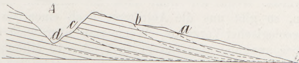
Fig. 285 Entstehung eines Durchbruchstales durch Rückeinschneiden eines Flusses von a bis d und Anzapfen des Längstales A
