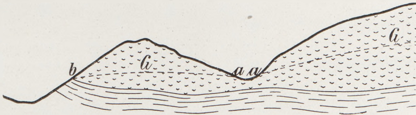
Fig. 288 Entstehung von Grundwasserquellen bei a, a und einer Grundwasser- überfallsquelle bei b . G, G Grundwasserspiegel in durchlässigem Gestein, das von undurchlässigem unterlagert wird.
