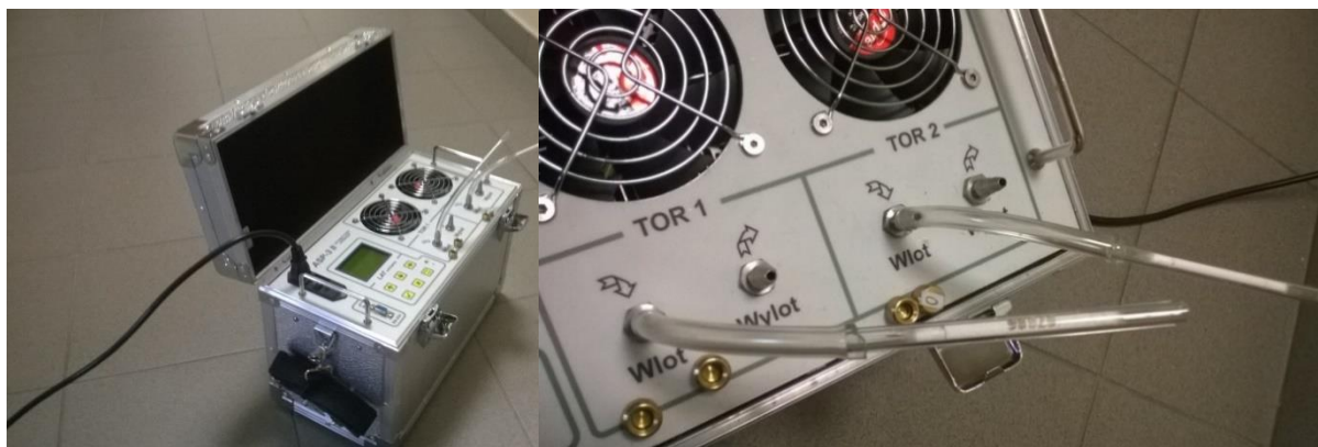
Rys. 6. Sposób pobierania próbek powietrza wewnętrznego na rurki sorpcyjne przy użyciu aspiratora automatycznego
