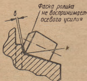
Рис. 2. Сопряжение ролика подшипника со шлифованным конусом червяка.
