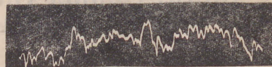
Рис. 4. Профилограмма шлифованной поверхности фаски клапана. Шлифовальный круг обработан алмазом.
