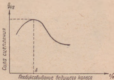
Рис. 2. Зависимость между силой сцепления и пробуксовыванием ведущего колеса.
