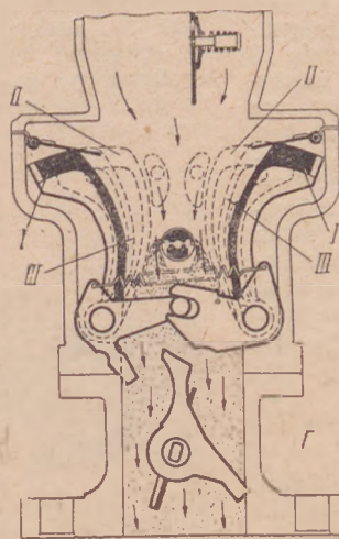
Рис. 2. Работа карбюратора на различных режимах.
