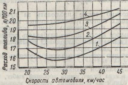
Рис. 2. Экономические характеристики автомобиля ГАЗ-51 при различных значениях выбеге: 1 — выбег 254 м; 2 — 221 м; 3 — 190 м; 4 — 173,7 м.
