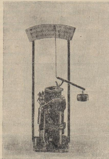
Рис. 4. Общий вид установки карбюратора К-49 на приборе.
