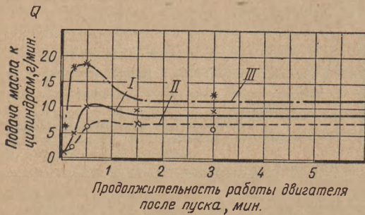
Рис. 3. Подача масла к цилиндрам двигателя.
