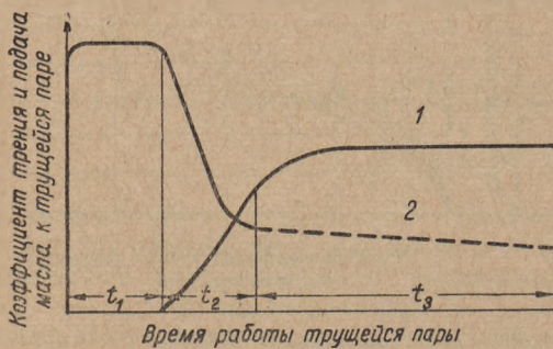
Рис. 4. Изменение коэффициента трения пары цилиндр — поршневое кольцо и подача масла при работе двигателя на пусковом режиме:
