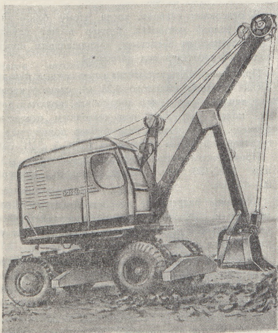
Рис. 1. Экскаватор-кран Э-255 на пневматических шинах.
