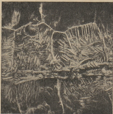
Рис. 2. Микроструктура зоны сплавления полуоси до термической обработки (ув. \times 100 ).
