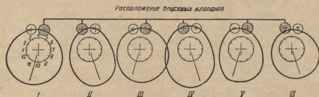
Рис. 1 (вверху). Эпюры износов стенок цилиндров двигателя автомобиля ГАЗ-51 после пробега 30 тыс. км.
