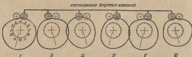
Рис. 1 (вверху). Эпюры износов стенок цилиндров двигателя автомобиля ГАЗ-51 после пробега 30 тыс. км.
